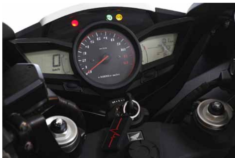
TRADISJONELL: Instrumenteringen er tradisjonell, med mekanisk turteller og digital tilleggsinformasjon.
