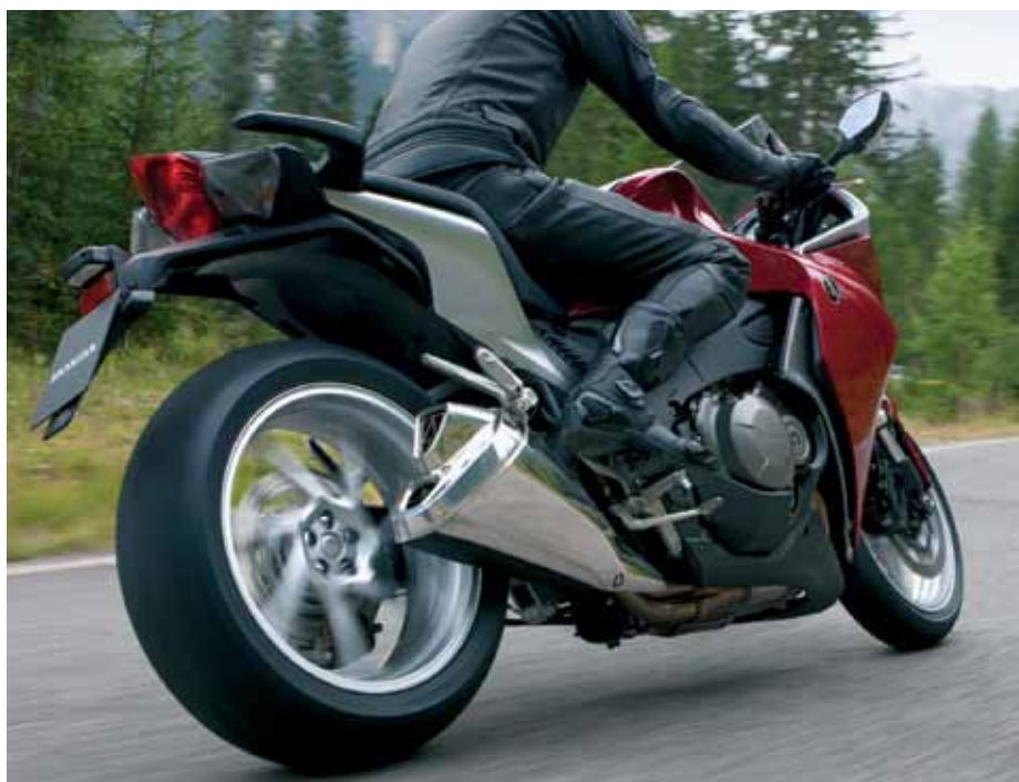
MYK KRAFTOVERFØRING: Drivakselen munner ut av motorblokka på undersiden av svingarms-opplagringen. Dette skal eliminere kardangreaksjonen. Drivlinja har også flere rykkutjevner som skal gjøre kraftoverføringen myk.
